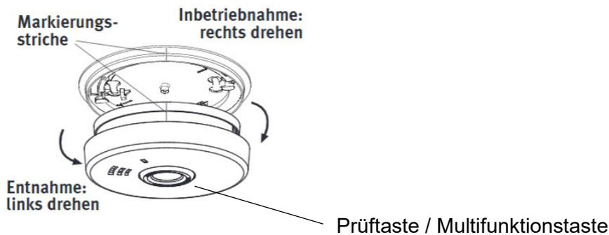
**!** Die Prüftaste wird 1 Sekunde gedrückt und ein relativ leiser Prüfalarm ertönt. Ein echter, sehr lauter Alarm wird ausgelöst, sobald die Taste länger als 5 Sekunden gedrückt wurde **!**
