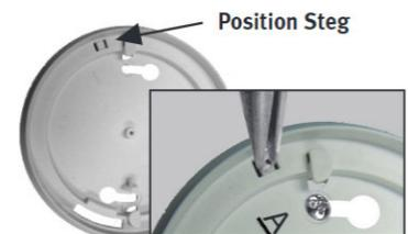
Wird nun der Rauchmelder auf den Montageteller gedreht, so rastet ein kleiner Zapfen, der sich an dem Rauchmelder befindet, in die Halterung ein. Soll der Rauchmelder wieder entfernt werden, so muss der Zapfen beim Herausdrehen einfach eingedrückt werden:
