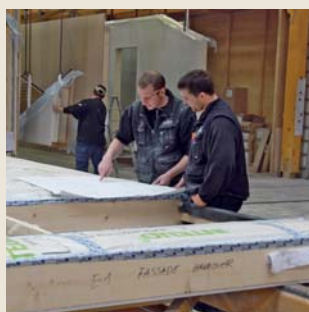
BAUFRITZ, Erkheim im Allgäu: Hier wurden die Fassadenelemente produziert.
